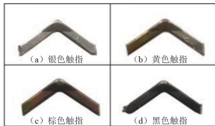
图 2 触指片 4 类腐蚀形态
