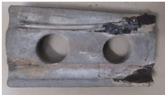
图 2 500 kV 地线并沟线夹腐蚀故障
