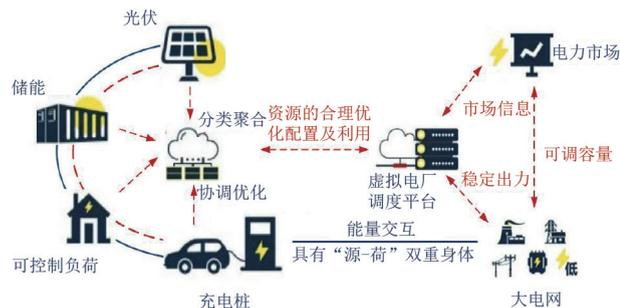
图 4 多元源荷储聚合的新型能源自治体系
