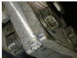
图 6 103 电流互感器 P2 端放电痕迹
