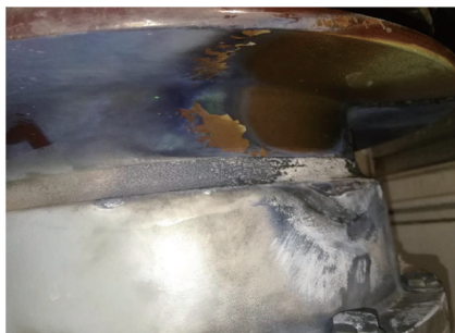
图4 103电流互感器底座放电痕迹
