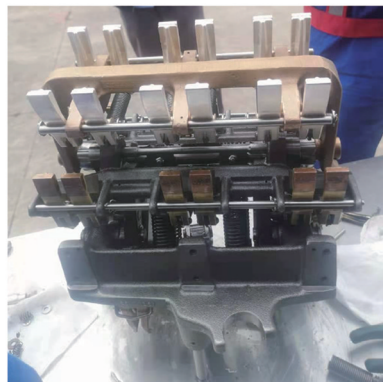
图 5 修复后的触头组
