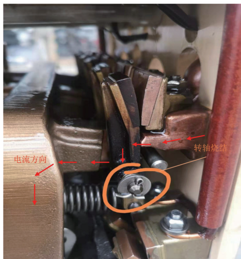
图 3 主动触头过热发黑现象
