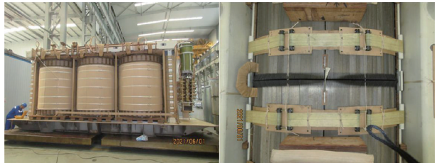
图 2 吊罩绕组、铁芯、夹件结构
