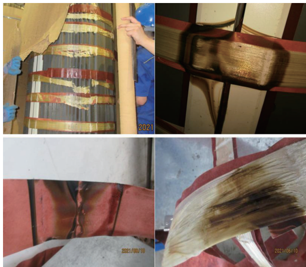
图 4 多处拉板、无纬带、绝缘纸板发黑
