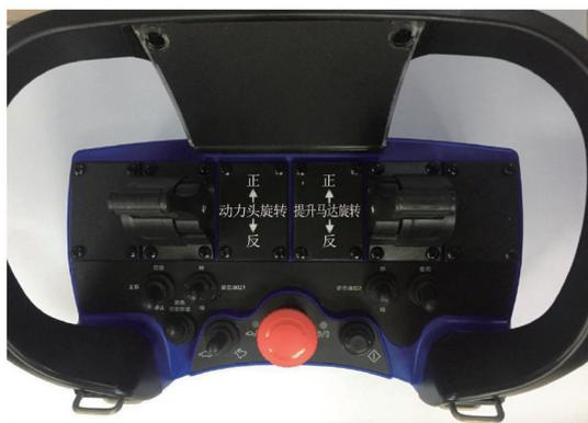
图 6 钻机遥控界面
