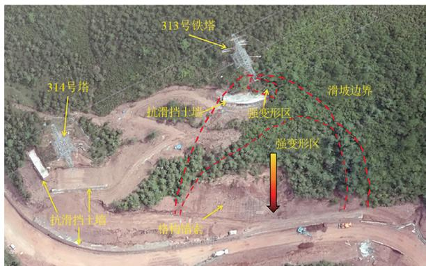
图 6 313 号铁塔滑坡区域无人机三维影像
