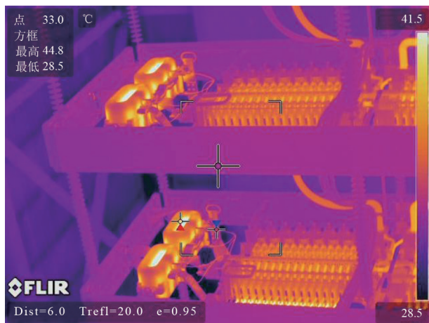
图9 新型饱和电抗器运行红外图谱
