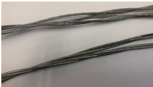
图 5 断口附近导线与正常导线钢芯表面形貌对比
