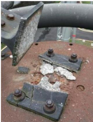
图1 铝合金接线板断裂
