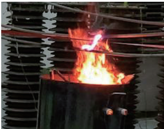
图 6 火焰相间导线试验
