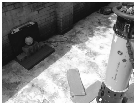
图9 支撑绝缘子现场 X 射线成像检测
