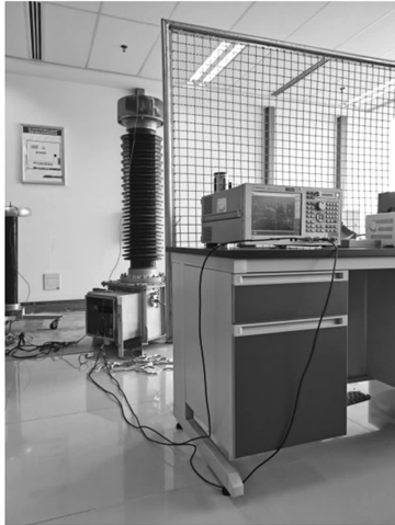
图4 AGILENT E5071C对CVT的测量
