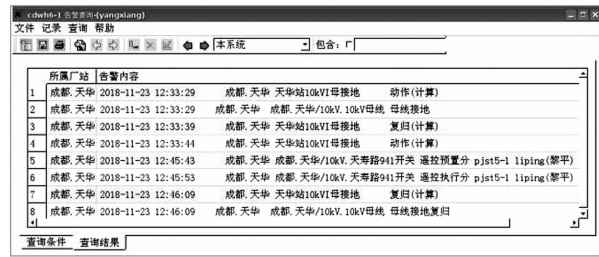
图 4 天华站接地故障后执行及状态反馈过程
