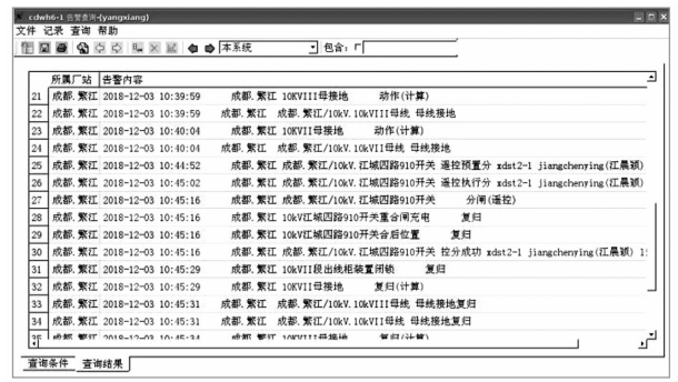
图 5 繁江站接地故障后执行及状态反馈过程
