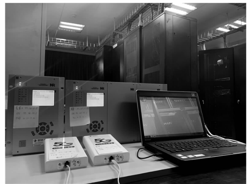
图6 试验室环境下5G纵差保护联机调试
