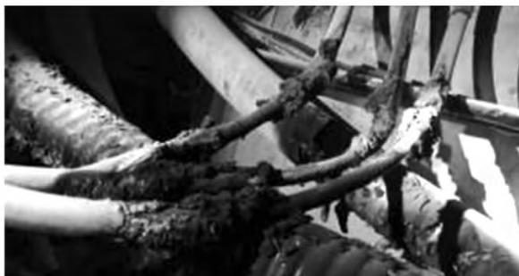
图2 电缆烧损故障火源起点
