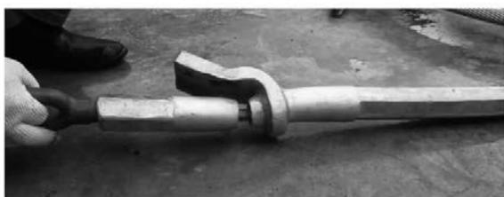
图2 耐张线夹铝管断裂位置
