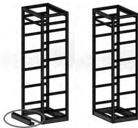
图2 屏柜后下横梁拆卸
