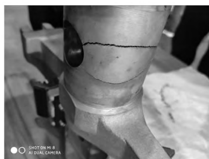
图 6 断裂的连接臂碎片拼接
