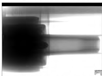
B 相灭弧室动静触头状态 (分闸)
