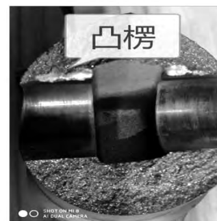
图11 连接臂连接孔断裂位置凸楞
