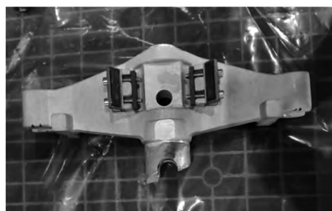
图 5 断裂的连接臂
