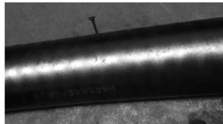
图3 高压电缆外破缺陷
