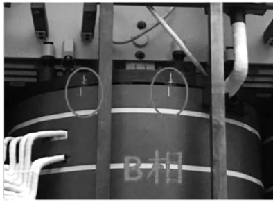
(a) 短路试验后划线错位
