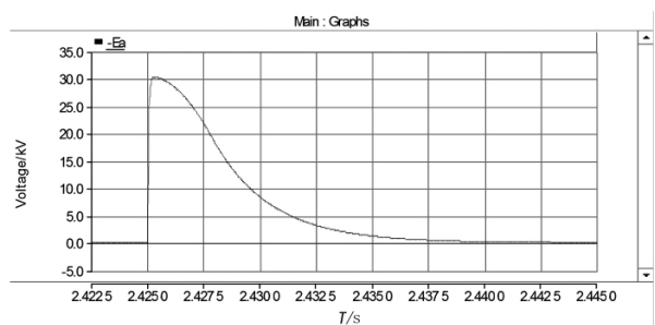
图 6 有耦合电容修正电路冲击电压发生器输出电压波形
