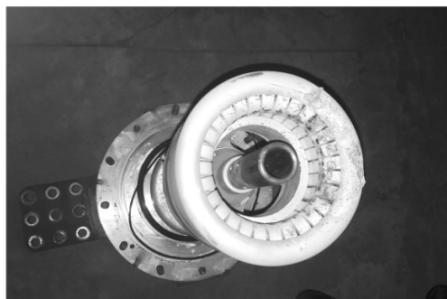
图4 静主触头及屏蔽罩烧灼情况
