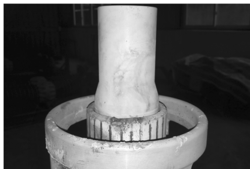
图5 动主触头、压气缸及绝缘喷嘴烧灼情况
