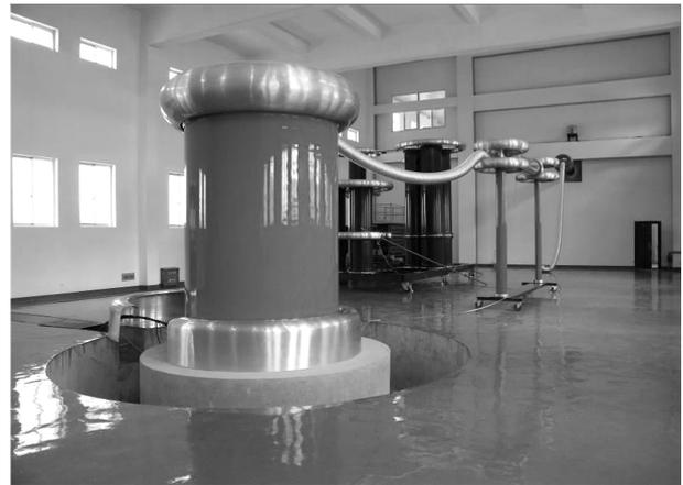
图 2 200 kV 交流污秽试验电源
