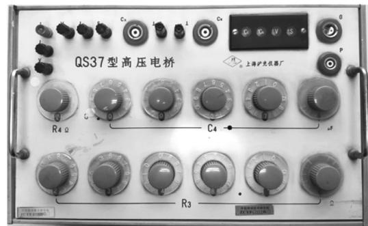
图3 QS-37型绝缘油介质损耗测试仪外观
