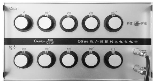
图 4 QS-40B 型绝缘油介质损耗测试仪外观
