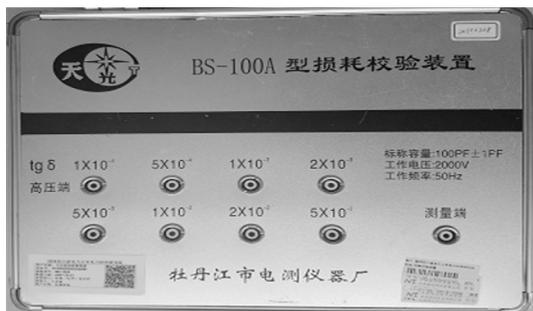
图2 BS-100A型绝缘油介质损耗校验装置的外观
