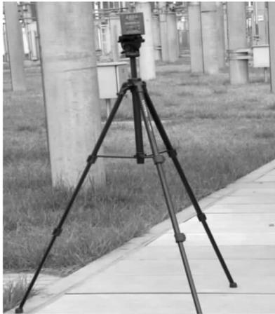
图 1 工频电场测试仪器实物
