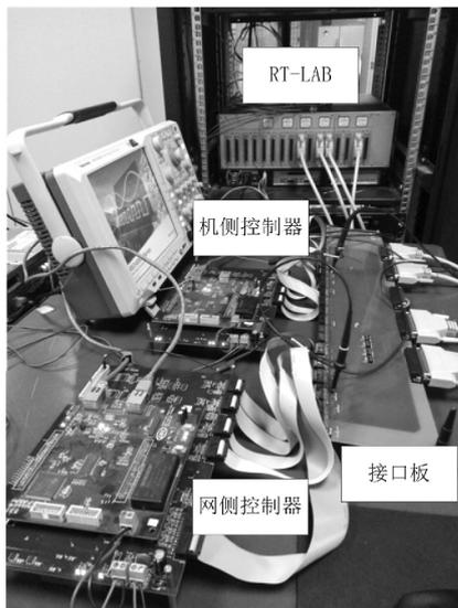
图 9 RT-LAB 硬件在环仿真实验系统
