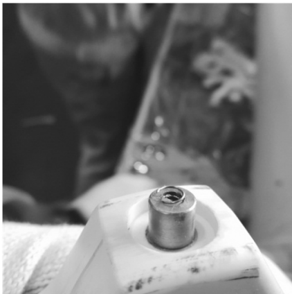
图8 绝缘子支撑螺钉末端金属弹簧安装图
