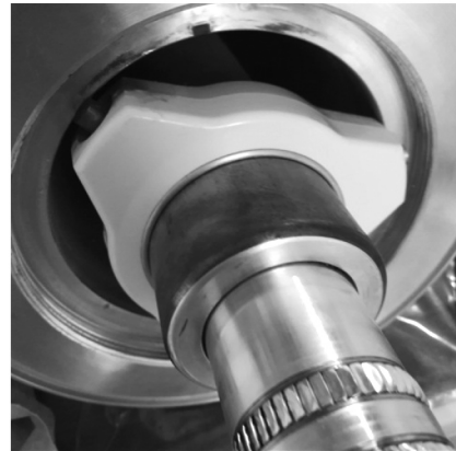
图 5 现场绝缘子局部放电痕迹
