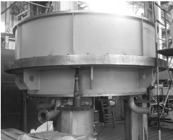
图9 改造后轴承装配厂内预装
