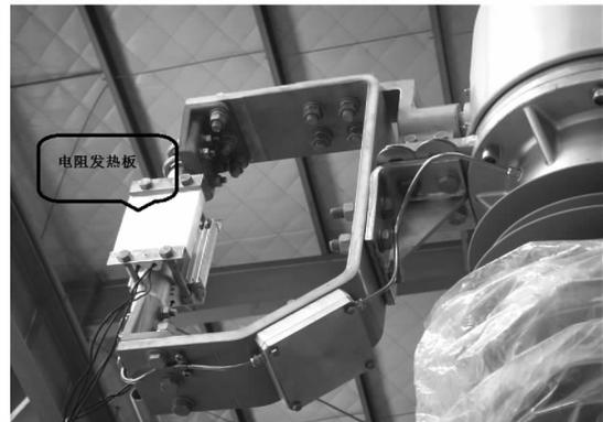
图 3 触头过热故障模拟装置
