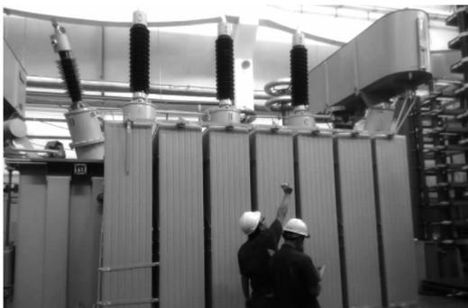
图8 电力变压器噪声控制与抑制实验系统
