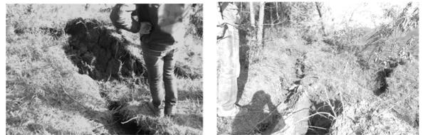
图5 314号塔位滑坡体上的拉张裂缝
