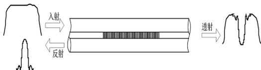
图1 光纤传感器的原理结构示意图
