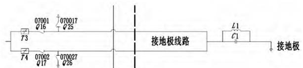
图8 宜宾站接地极线路电流互感器配置图
