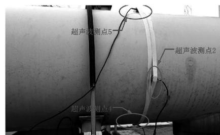
图 11 多通道超声波局部放电定位
