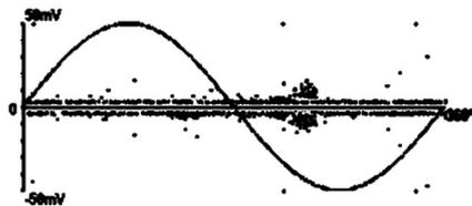
图6 GIS导体毛刺产生的超声波相位聚集图谱
