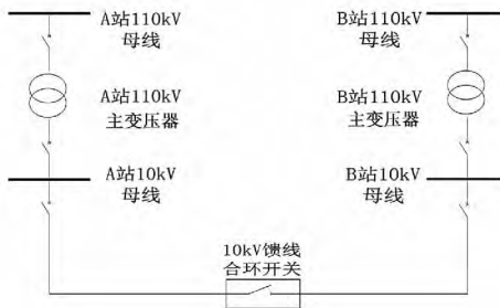
图1 同一电压等级不同变电站的中压馈线合环
