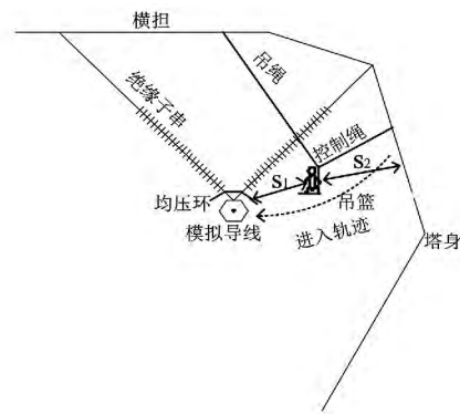
图5 塔上吊篮法进入上相等电位
