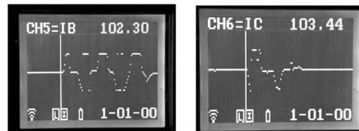
图3 斑肖线B、C相故障电流波形图
