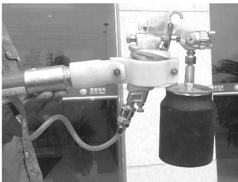
图1 绝缘气动清扫机
