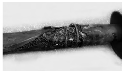
图1 电缆绝缘老化击穿部位(铜辫接地处)
