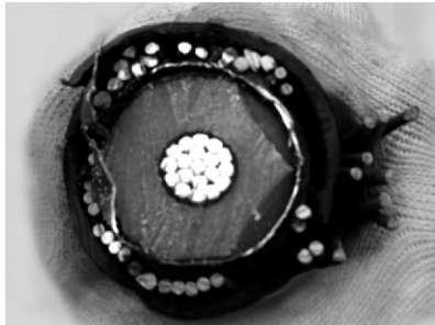
图2 故障电缆横切面分布
