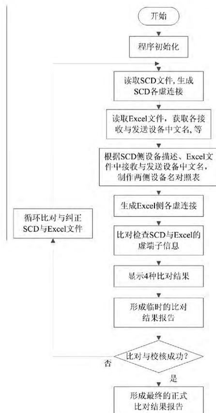
图1 SCD智能比对软件的流程图
