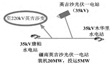
图 2 光伏一电站“T”型接线图
