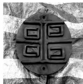
图4 防水盖没有涂密封胶
