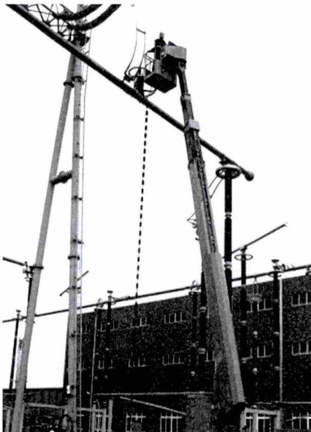
图5 ±500 kV 德阳换流站极线 OTA 试验场景 分析此次校准试验,可以得到如下几点结论。
