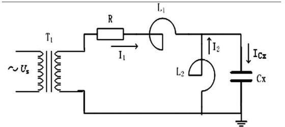
$T_1$  为励磁变压器;  $R$  为回路等效电阻;
