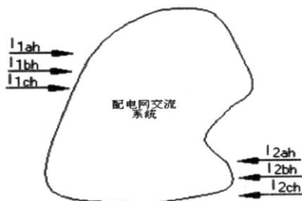
图 1 不平衡电流注入配网系统
