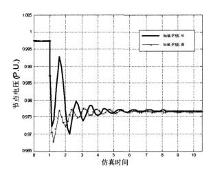
图 6 PSS对母线电压振荡的影响
