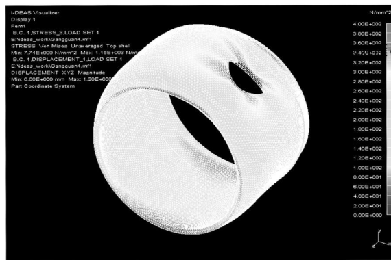
图 10 实体单元离散时的 Von Mises 等效应力分布图
