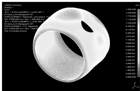
图 9 实体单元离散时的整体变形图
