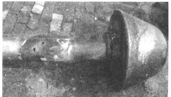
图 2 损坏的灰控阀阀杆和阀心
