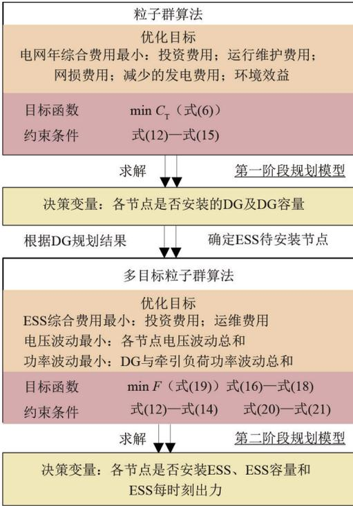
图5 两阶段规划架构
